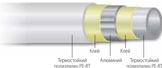
Структура металлопластиковой трубы Uronor MLC
