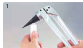
1 Смажьте конус инструмента графитовой смазкой Uponor
