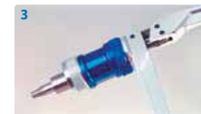
3 Прикрутите к насадке-вращателю расширительную головку Q&E
