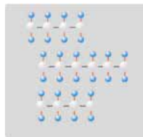
Молекулярная структура обычного полиэтилена
