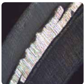
Шов алюминия, сваренного внахлест
