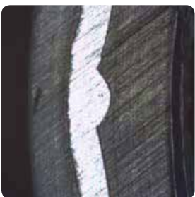
Шов алюминия, сваренного встык
